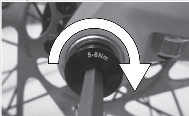
Figura 31: Apriete del tornillo de seguridad
