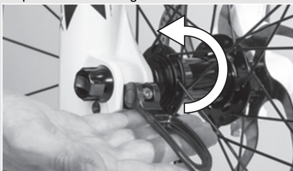
Figura 37: Seguridad de la palanca
