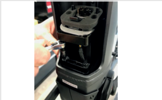
Figura 23: Retirada de los tornillos hexagonales de 4 mm
