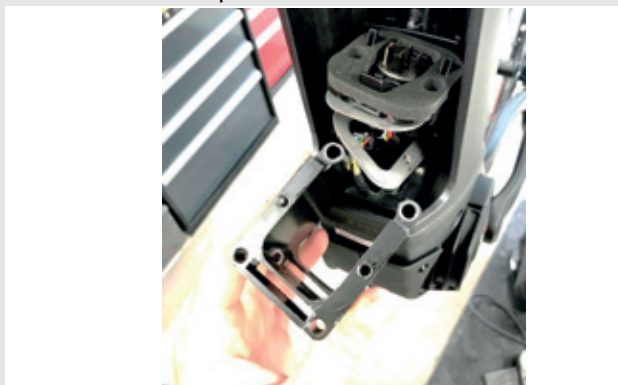
Figura 25: Extracción del adaptador PowerTube
