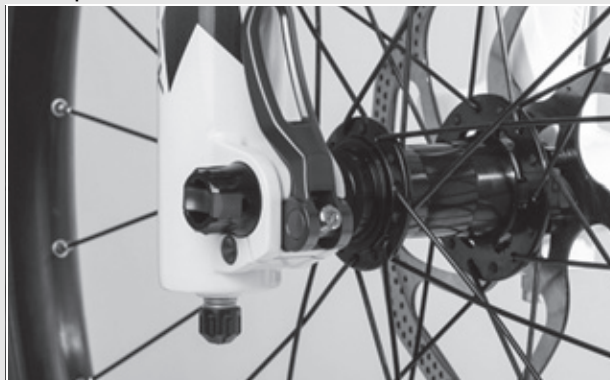
Figura 38: Posición perfecta de la palanca tensora
