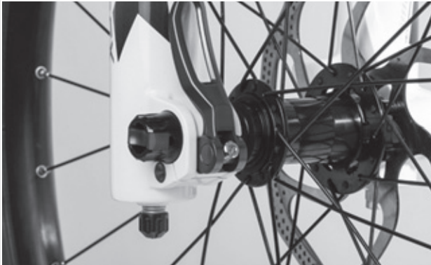
Figura 67: Ajuste de la fuerza de tensado del cierre rápido
