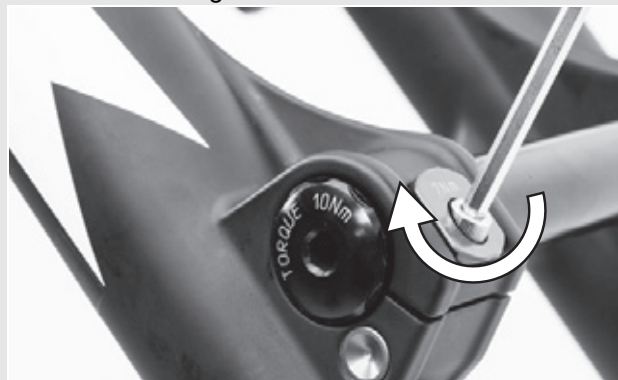
Figura 33: Apretar la abrazadera de sujeción
