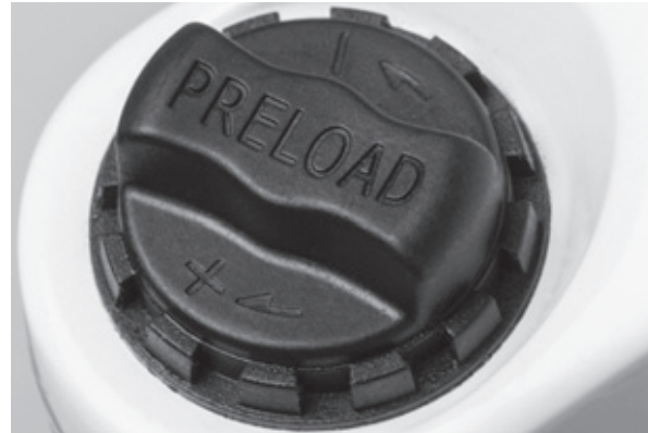
Figura 55: Rueda de ajuste del recorrido negativo de muelle en la corona de la horquilla de suspensión
