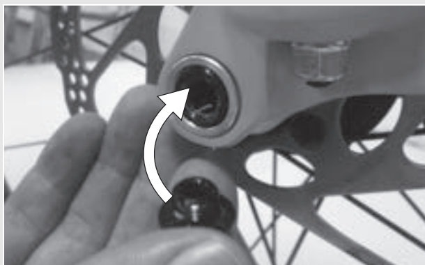
Figura 30: Inserción de la palanca de cierre rápido en el eje
