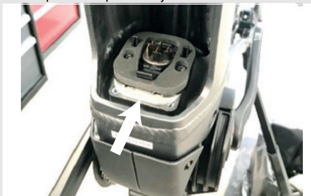
Figura 26: Placas adaptadoras montadas
