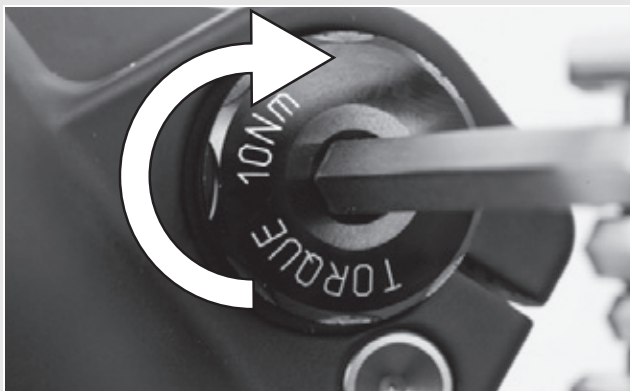
Figura 32: Apriete del eje insertado
