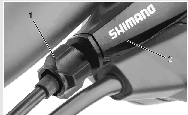
Figura 69: Casquillo de ajuste (1) del cambio de marchas accionado por cable de accionamiento con carcasa de la palanca de cambio (2), ejemplo
