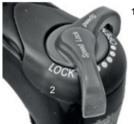
Afbeelding 55: Suntour-drukdemperafsteller met de standen OPEN (1) en LOCK (2)
