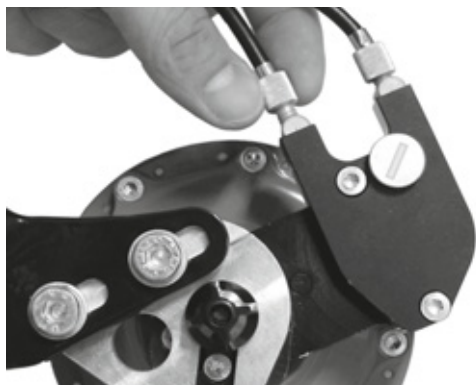
156 paveikslėlis. „Rohloff“ stebulės variantas su išoriniu perjungimo valdymu turi traukimo reguliatorius ant kabelių dėžės, kuri yra kairėje
