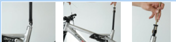
191 paveikslėlis. Pritvirtinkite kasetės vožtuvo dangtelį
