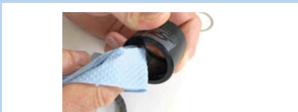
175 paveikslėlis. Išvalykite išorinę movą
