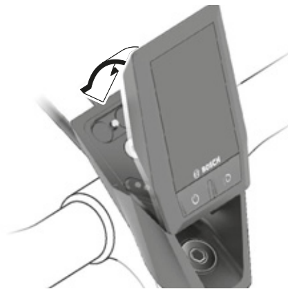
124 paveikslėlis. Borto kompiuterio pavertimas
