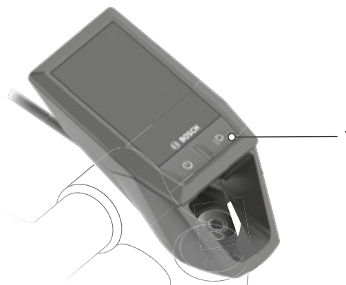
139 paveikslėlis. Važiavimo žibintų mygtuko vieta
