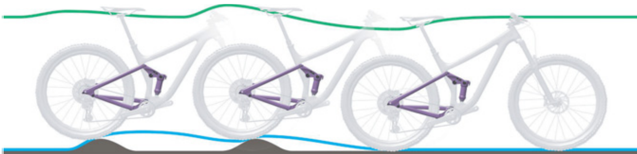
235 paveikslėlis. Per lėtas galinio amortizatoriaus atšokimas
