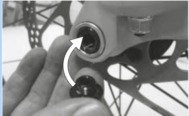
69 paveikslėlis. Ekscentriko įstūmimas į ašį
