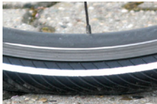
102 paveikslėlis. Tinkamas pripildymo slėgis. Padanga vos deformuota veikiant kūno svoriui
