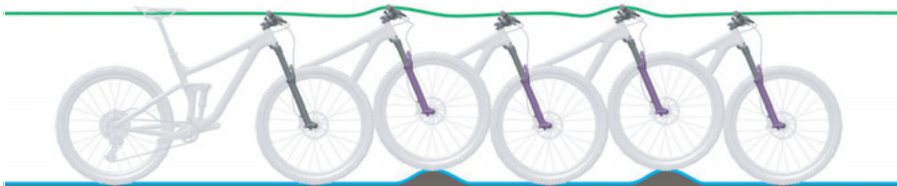
Obr. 9: Optimální chování vidlice při jízdě
