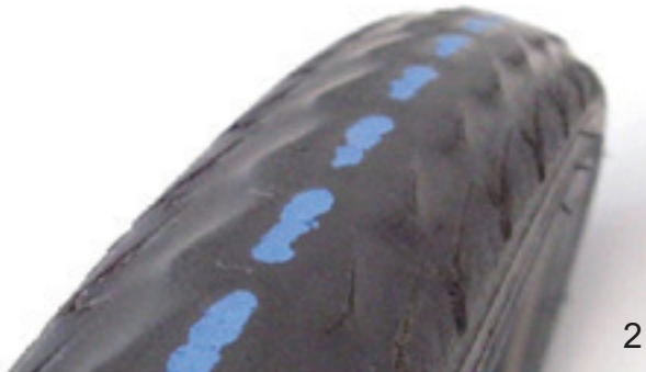
Obr. 158: Pneumatika bez běhounu, na které lze ještě jezdit (1), a pneumatika s proraženou ochranou (2), kterou je třeba vyměnit
