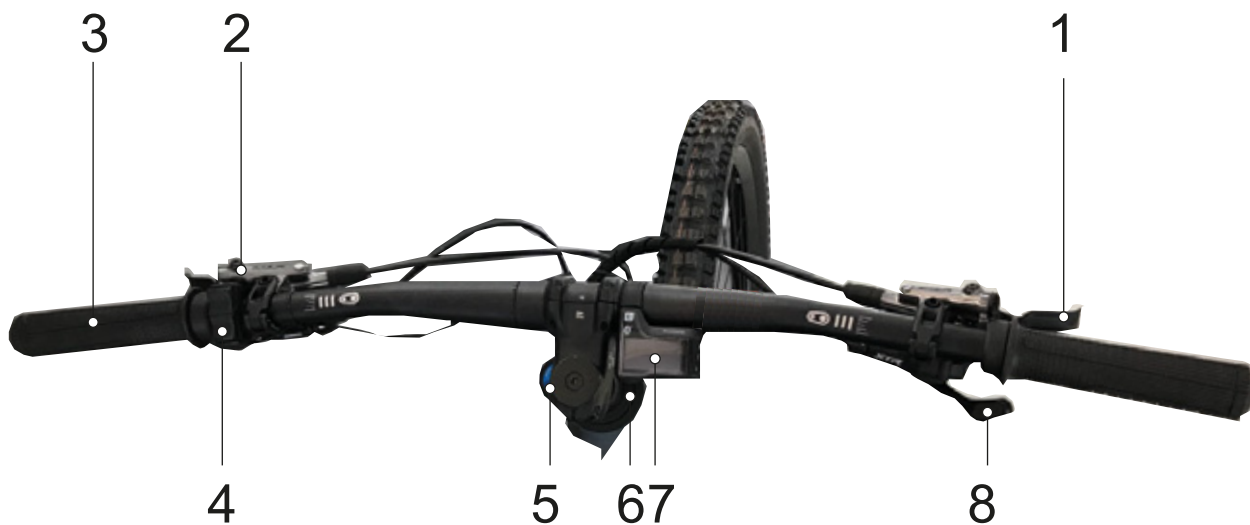
Obr. 45: Detailní pohled na řídítka s palubním počítačem SHIMANO SC-E800, příklad
