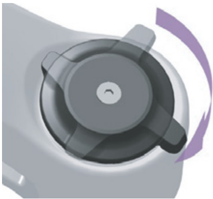
Obr. 238: Tvrdé nastavení nastavovacího šroubu komprese
