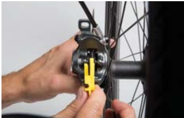
Obr. 160: Kontrola brzdového obložení v namontovaném stavu pomocí přepravní pojistky
