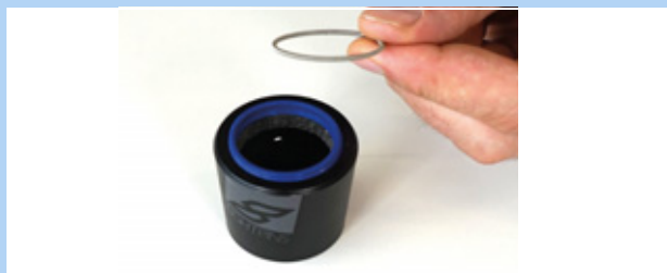
Obr. 180: Vyjmutí pružné podložky
