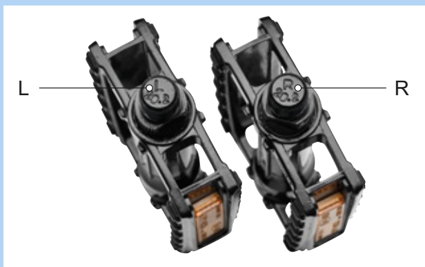
Obr. 58: Příklad označení pedálů
