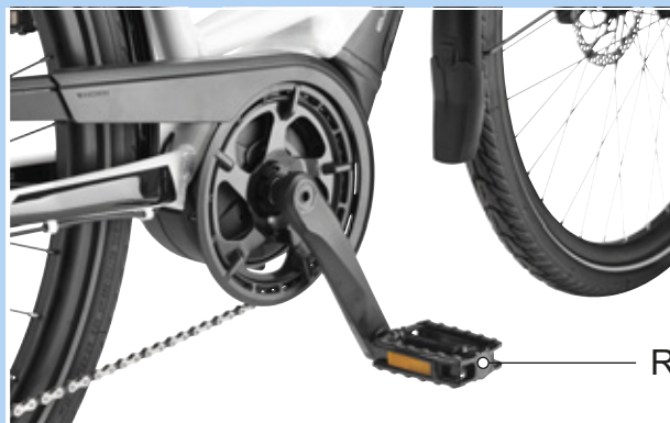
Obr. 60: Pedál R pravého ramena kliky
