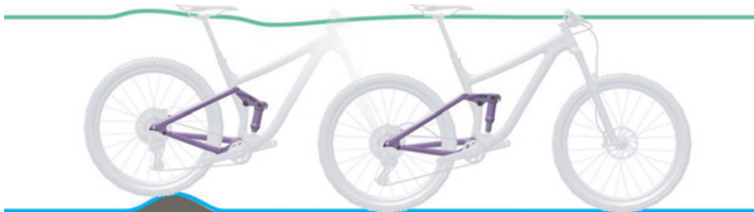
Obr. 18: Optimální chování tlumiče zadního odpružení při jízdě u nerovností
