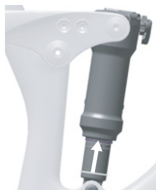
Obr. 106: Posunutí O-kroužku na tlumiči zadního odpružení
