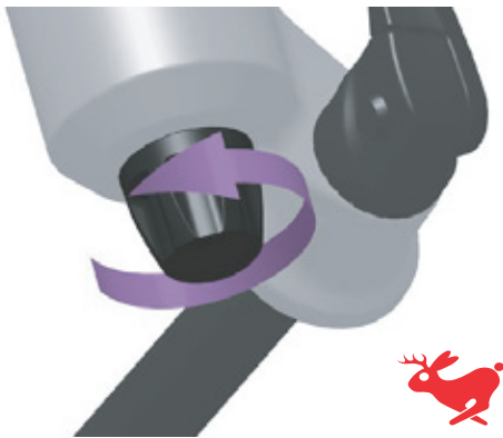
Obr. 236: Otočení šroubu odskoku směrem k zajíci
