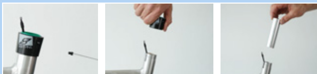
Obr. 179: Demontáž vnějšího pouzdra a kluzného pouzdra
