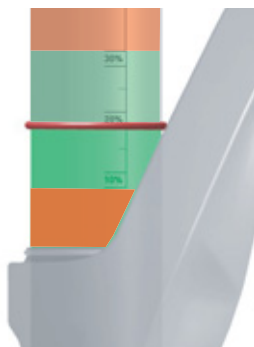
Obr. 104: Předepsaný rozsah SAG (zelený) a zakázaný rozsah SAG (červený)
