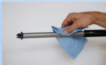
Obr. 224: Očištění podélné vodicí drážky
