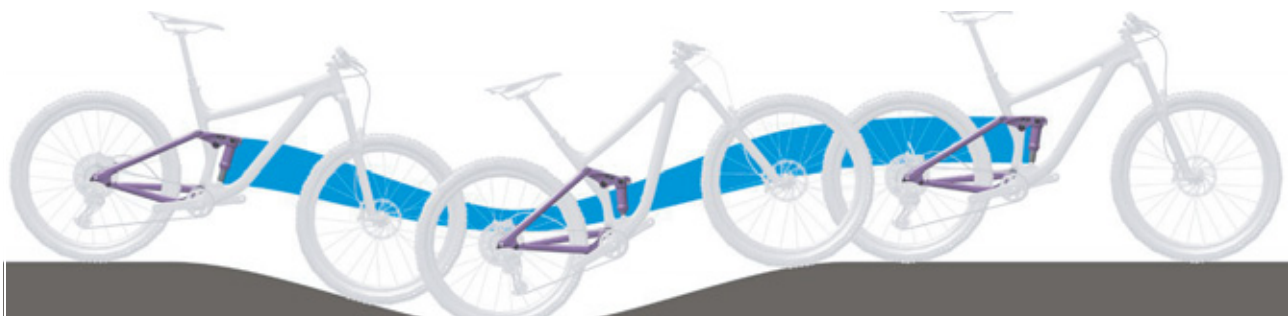
Obr. 245: Příliš měkké odpružení tlumiče zadního odpružení v horách
