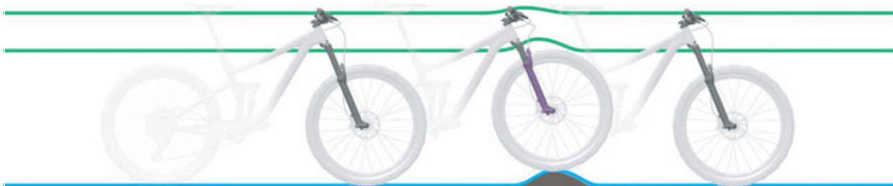
Obr. 11: Optimální chování vidlice při jízdě u nerovností
