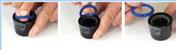
Obr. 181: Vytážení stíracího kroužku
