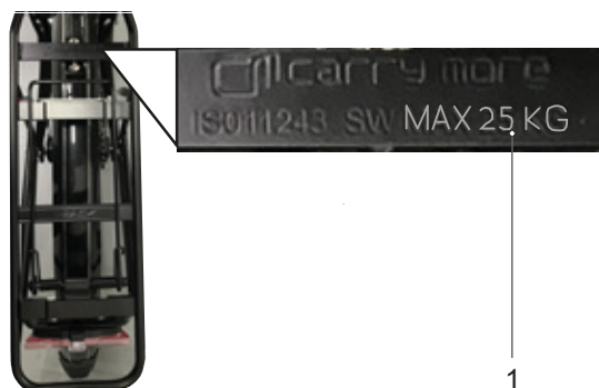
Obr. 133: Na nosiči zavazadel je uvedena jeho maximální nosnost (1)
