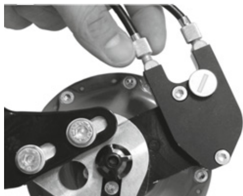
Obr. 164: Náboje Rohloff s externím ovládním řazení mají seřizovače napnutí na lanovodu, který je umístěn na levé straně
