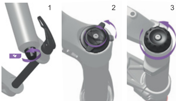
Obr. 101: Otevření odskoku (1) a tlumiče komprese (2 a 3)
