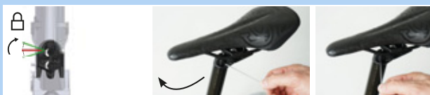
Obr. 208: Zavření nastavení výšky
