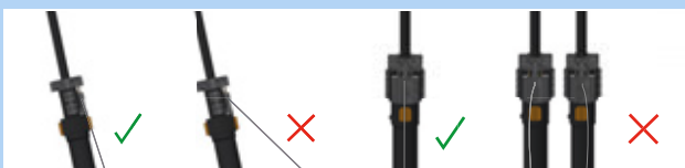
Obr. 198: Správné a nesprávné vedení bovdenů
