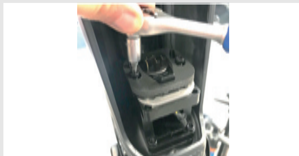
Obr. 22: Povolení šroubů držáku akumulátoru
