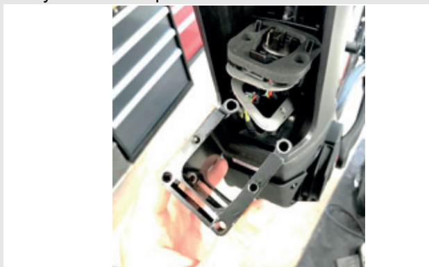
Obr. 25: Vytažení adaptéru PowerTube
