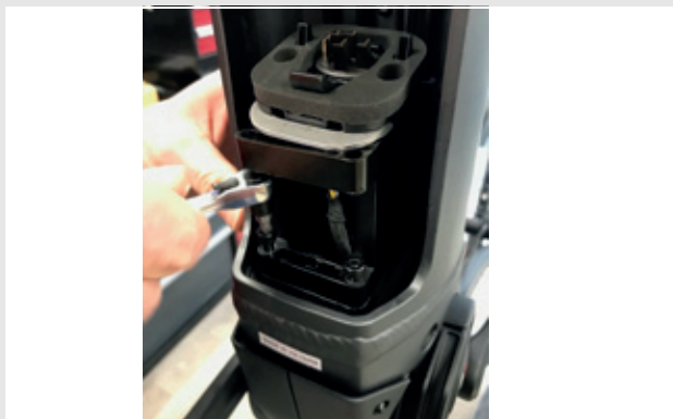
Obr. 23: Odstranění 6hranných šroubů 4 mm
