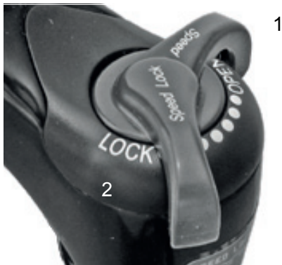
Obr. 64: Nastavovací šroub komprese Suntour s polohami OPEN (1) a LOCK (2)
