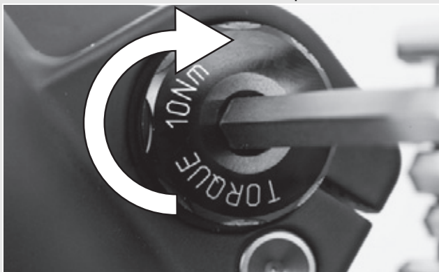
Obr. 32: Utažení zasunuté osy
