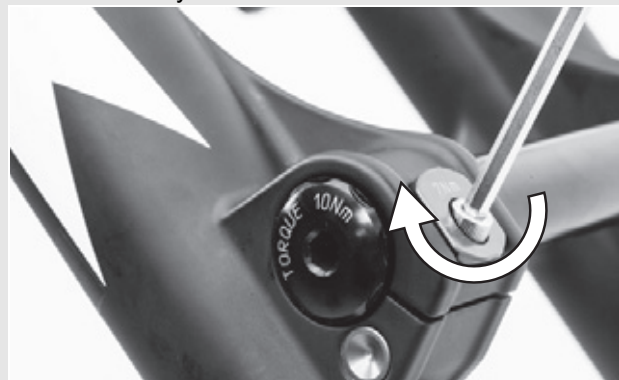
Obr. 33: Utažení pojistné svorky
