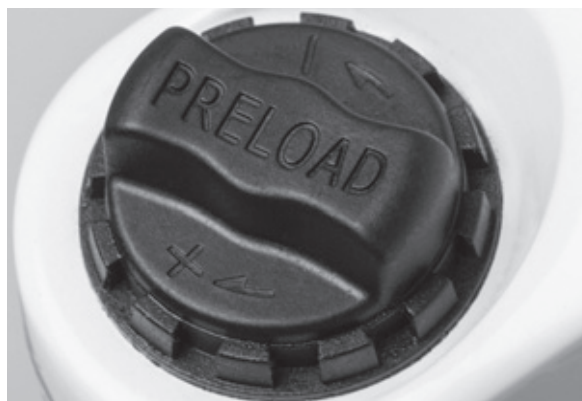
Obr. 55: Nastavovací kolečko zanoření na korunce odpružené vidlice
