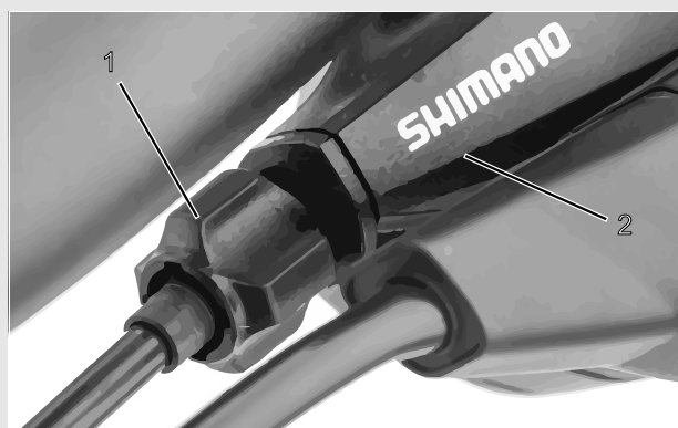
Obr. 69: Seřizovací pouzdro (1) řazení převodů ovládané jedním lankem s řadicí páčkou (2) - příklad
