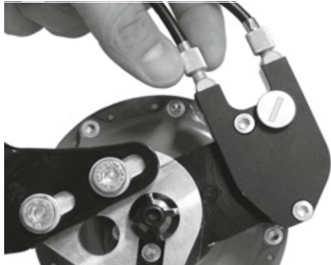
Obr. 149: Náboje Rohloff s externím ovládním řazení mají seřizovače napnutí na lanovodu, který je umístěn na levé straně
