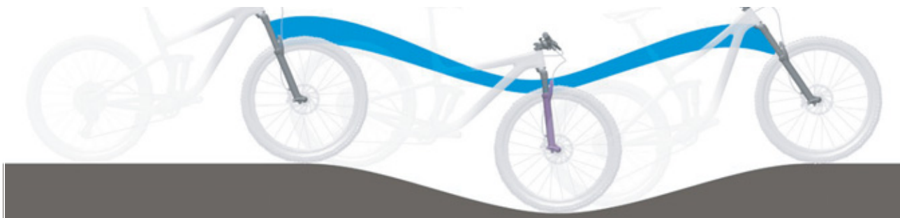
Obr. 222: Příliš měkké odpružení odpružené vidlice v horách
