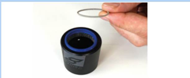
Obr. 200: Vyjmutí pružné podložky
