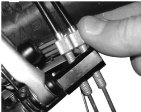
Obr. 148: Náboje Rohloff s vnitřním ovládním řazení mají nastavovače napnutí na držáku protitahu
