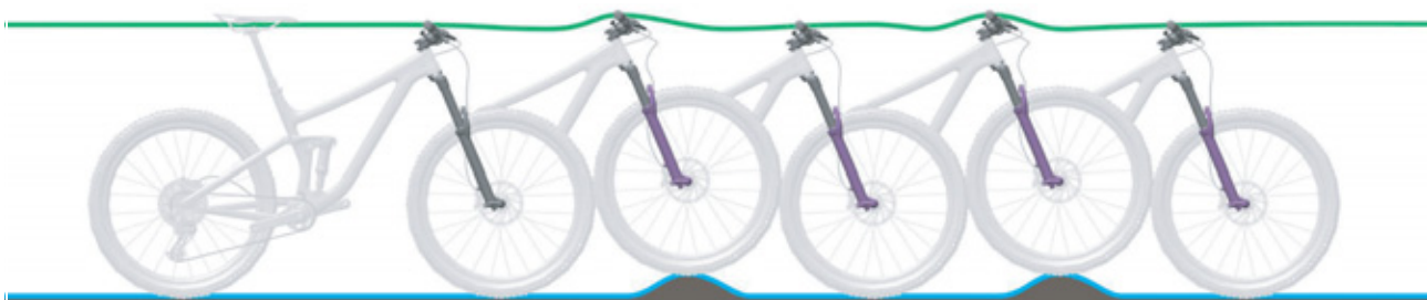
Obr. 114: Optimální chování vidlice při jízdě
