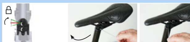
Obr. 193: Zavření nastavení výšky
