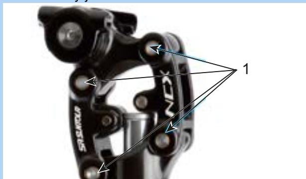
Obr. 155: Mazací body odpružené sedlovky Suntour SR
