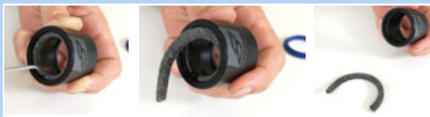
Obr. 167: Odstranění plstěného kroužku
