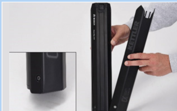
Obr. 60: Nasunutí krytu na akumulátor
