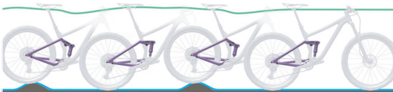
Obr. 115: Optimální chování tlumiče zadního odpružení při jízdě
