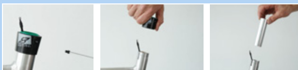
Obr. 204: Demontáž vnějšího pouzdra a kluzného pouzdra
