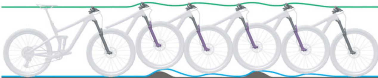
Obr. 224: Příliš rychlé roztahování odpružené vidlice
