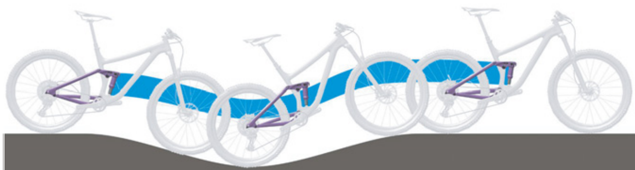
Obr. 20: Optimální chování tlumiče zadního odpružení při jízdě v kopcovitém terénu
