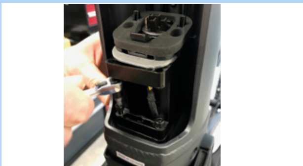
Obr. 53: Odstranění 6hranných šroubů 4 mm
