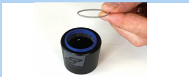
Obr. 171: Vyjmutí pružné podložky
