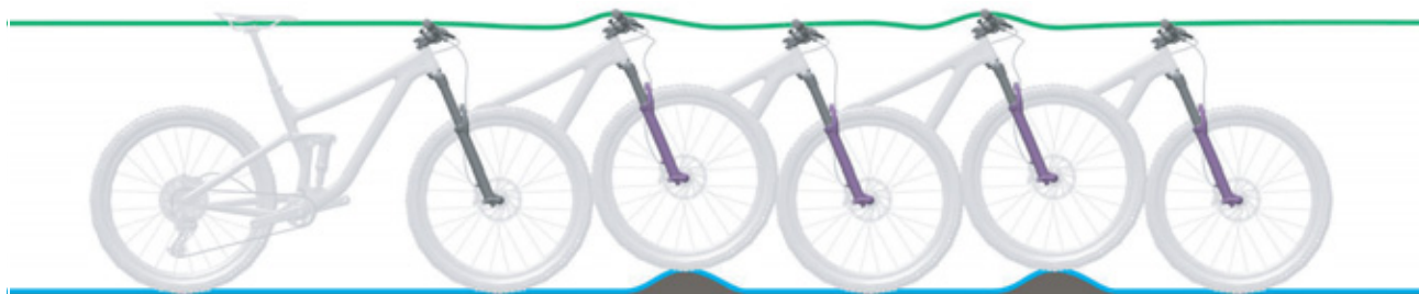
Obr. 11: Optimální chování vidlice při jízdě
