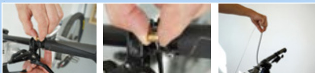
Obr. 201: Uvolnění dálkového ovládání
