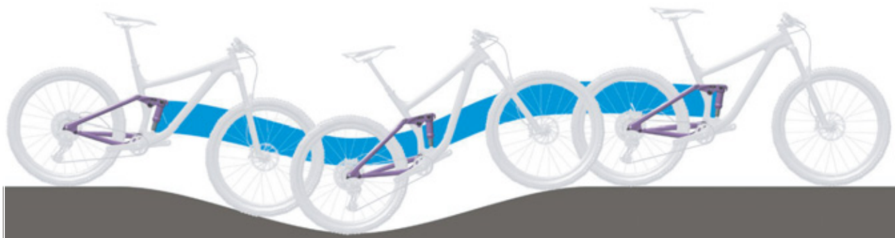
Obr. 16: Optimální chování tlumiče zadního odpružení při jízdě v kopcovitém terénu
