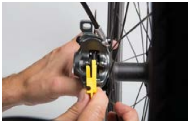
Obr. 151: Kontrola brzdového obložení v namontovaném stavu pomocí přepravní pojistky
