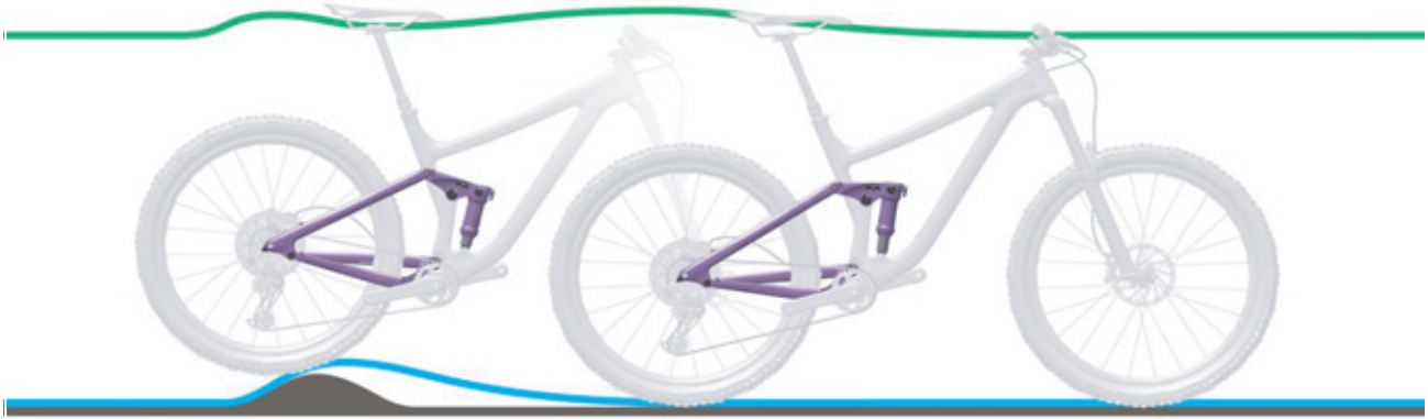
Obr. 238: Příliš tvrdé tlumení tlumiče zadního odpružení u nerovnosti
