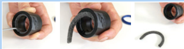
Obr. 173: Odstranění plstěného kroužku
