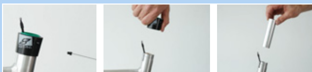
Obr. 170: Demontáž vnějšího pouzdra a kluzného pouzdra
