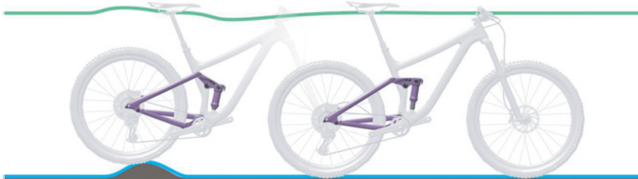
Obr. 117: Optimální chování tlumiče zadního odpružení při jízdě u nerovností
