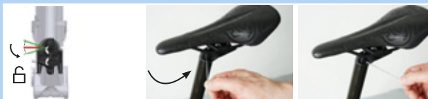
Obr. 162: Přesuňte ovladač nastavení výšky do polohy „Otevřeno“
