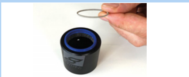
Obr. 206: Vyjmutí pružné podložky
