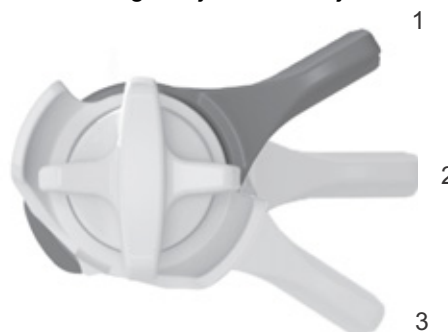
Afbeelding 73: FOX-drukdemperafsteller op de achterbouwdemper met de standen OPEN (1), MIDDEL (2) en HARD (3)
