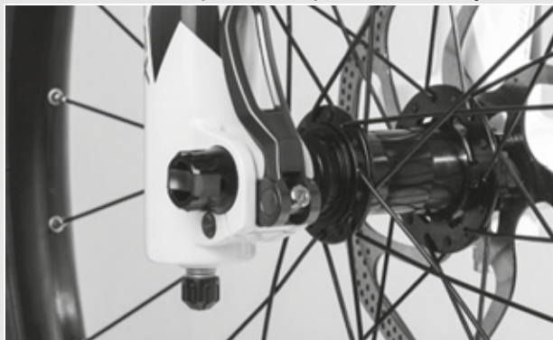
Afbeelding 79: Spankracht van de snelspanner afstellen
