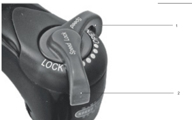
Rysunek 214: Ustawienie nastawnika dobicia na twardszy tryb pracy
