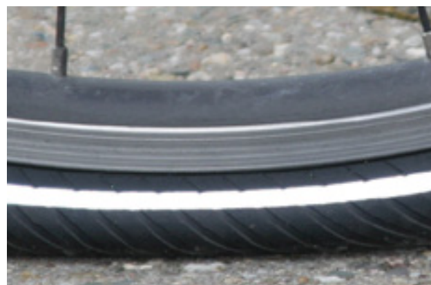
Rysunek 94: Zbyt niskie ciśnienie w oponie
