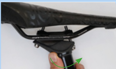
Rysunek 198: Otwieranie mechanizmu regulacji wysokości
