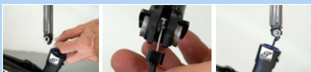
Rysunek 205: Zaczepianie i wsuwanie sztycy podsiodłowej
