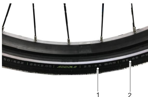
Rysunek 133: Ciśnienie w oponach w barach (1) i psi (2)
