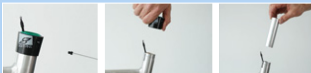
Rysunek 189: Demontaż tulei zewnętrznej i tulei ślizgowej
