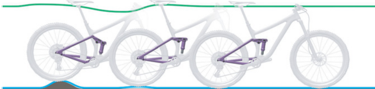
Rysunek 217: Zbyt szybkie rozprężanie się tylnego amortyzatora
