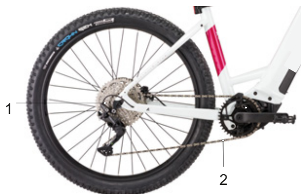
Rysunek 32: Schemat napędu łańcuchowego z przerzutką
