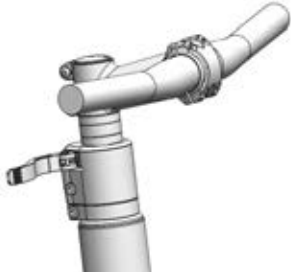
Rysunek 127: Przykład kierownicy typu All Up z otwartą dźwignią mocującą mostek
