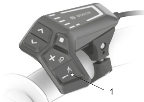
Rysunek 124: Położenie przycisku mechanizmu wspomagającego pchanie (1)
