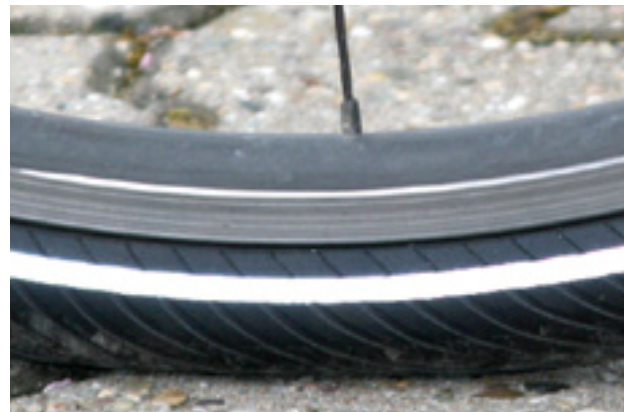
Rysunek 93: Prawidłowe ciśnienie w oponach. Opona prawie nie odkształca się pod wpływem ciężaru ciała
