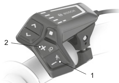
Rysunek 125: Położenie przycisków Plus i Minus
