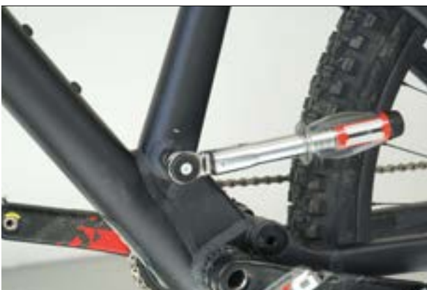
Rysunek 71: Dociąganie osi sztycy podsiodłowej
