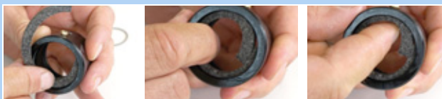
Rysunek 160: Wkładanie pierścienia filcowego
