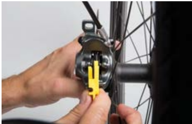
Rysunek 136: Sprawdzenie stanu klocków hamulca w stanie zamontowanym za pomocą zabezpieczenia transportowego
