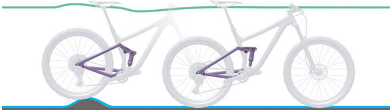
Rysunek 102: Optymalne działanie tylnego amortyzatora na nierównościach
