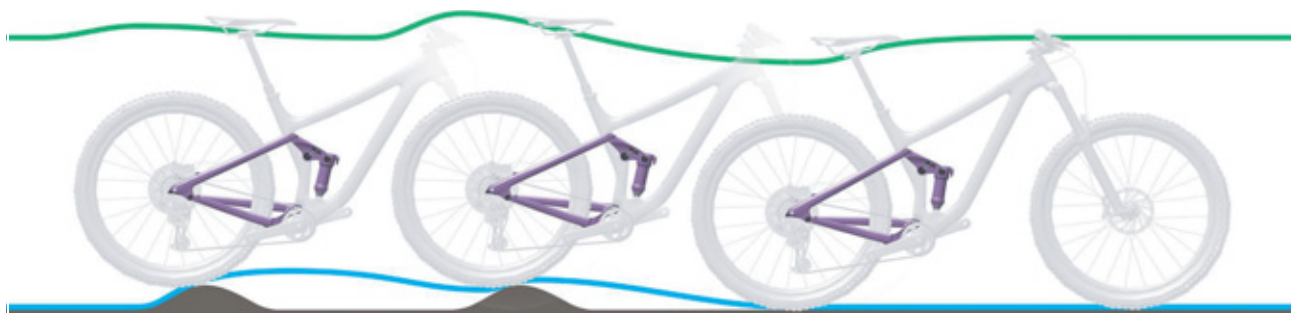
Rysunek 219: Zbyt wolne rozprężanie się tylnego amortyzatora
