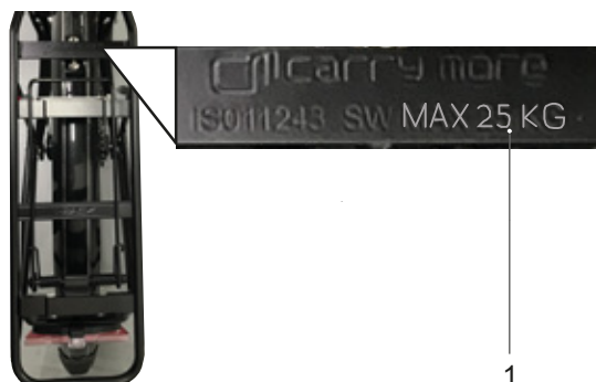
Rysunek 116: Na bagażniku umieszczona jest informacja o jego maksymalnej nośności (1)
