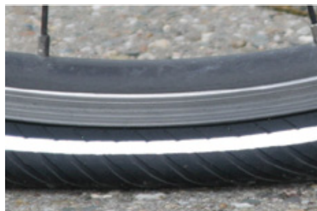
Rysunek 88: Zbyt niskie ciśnienie w oponie
