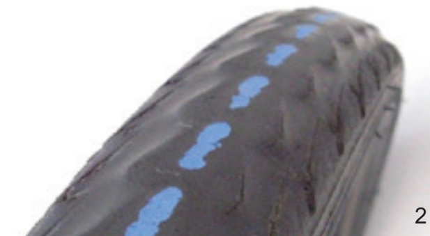
Rysunek 134: Opona bez bieżnika, która jeszcze nadaje się do jazdy (1) i opona z prześwitującą ochroną przed przebiciem (2), którą należy wymienić
