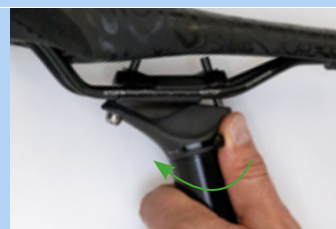
Rysunek 203: Zamykanie mechanizmu regulacji wysokości
