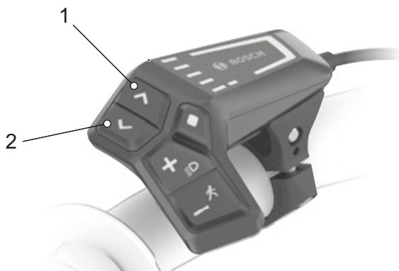
Rysunek 123: Położenie przycisku zwiększania jasności (2) i przycisku zmniejszania jasności (1)
