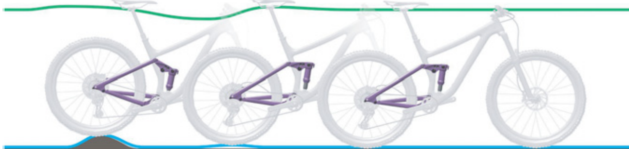
Rysunek 233: Zbyt szybkie rozprężanie się tylnego amortyzatora
