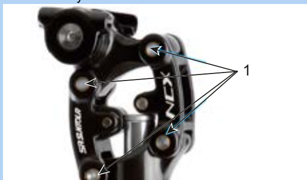
Rysunek 162: Punkty smarowania amortyzowanej sztycy podsiodłowej Suntour SR
