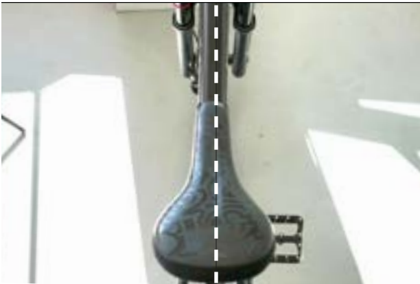
Rysunek 85: Ustawianie siodełka zgodnie z kierunkiem jazdy
