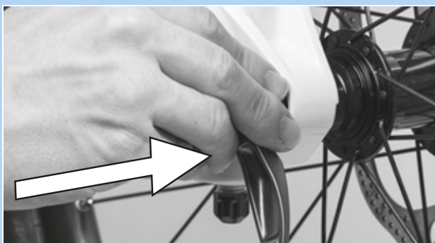
Rysunek 78: Wcisnąć zacisk szybko mocujący zgodnie z kierunkiem strzałki
