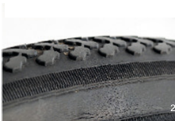
Rysunek 151: Przykłady pęknięć zmęczeniowych (1) i w wyniku starzenia się (2)
