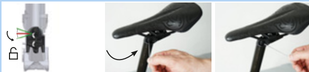
Rysunek 163: Ustawianie mechanizmu regulacji wysokości w pozycji „otwartej”.
