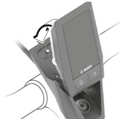
Rysunek 124: Zatraskiwanie komputera pokładowego
