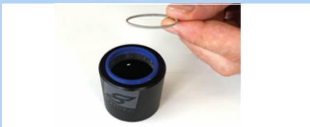
Rysunek 172: Wyciągnięty pierścień sprężysty
