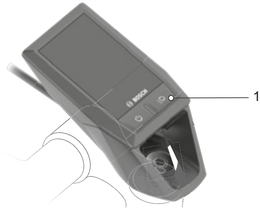
Rysunek 139: Położenie przycisku świateł do jazdy
