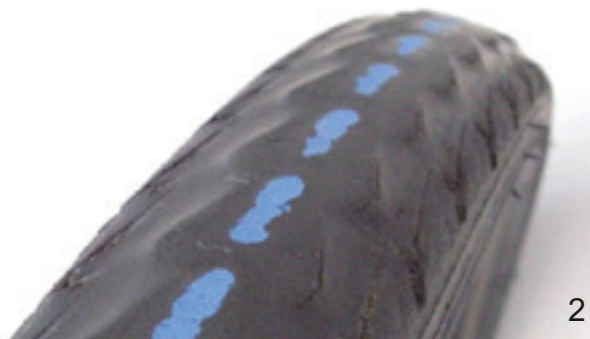
Rysunek 150: Opona bez bieżnika, która jeszcze nadaje się do jazdy (1) i opona z prześwitującą ochroną przed przebicciem (2), którą należy wymienić
