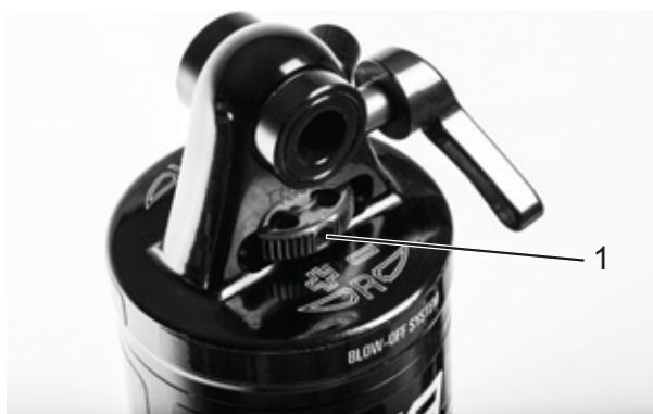
Rysunek 234: Nastawnik odbicia koła Suntour (1) na tylnym amortyzatorze
