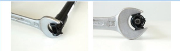
Rysunek 184: Zabezpieczenie przed przekręceniem się
