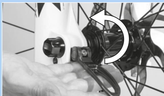
Rysunek 74: Docisnąć dźwignię zacisku szybkomocującego zgodnie z kierunkiem strzałki
