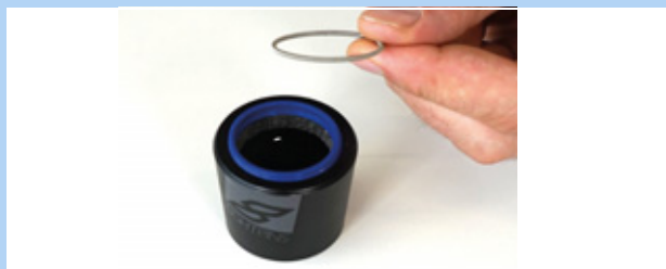
Rysunek 207: Wyciągnięty pierścień sprężysty
