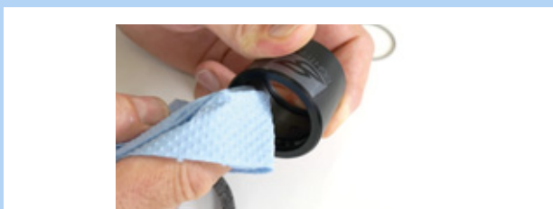
Rysunek 175: Czyszczenie tulei zewnętrznej
