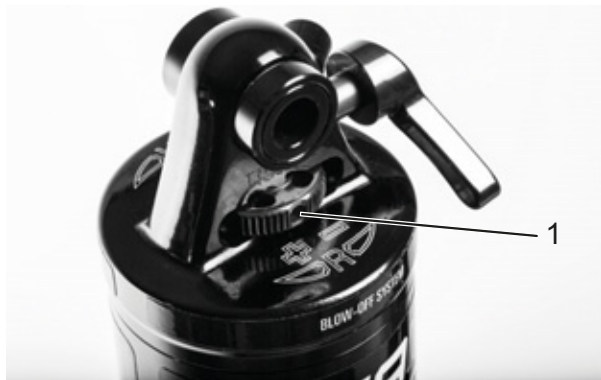
Rysunek 236: Nastawnik odbicia koła Suntour (1) na tylnym amortyzatorze
