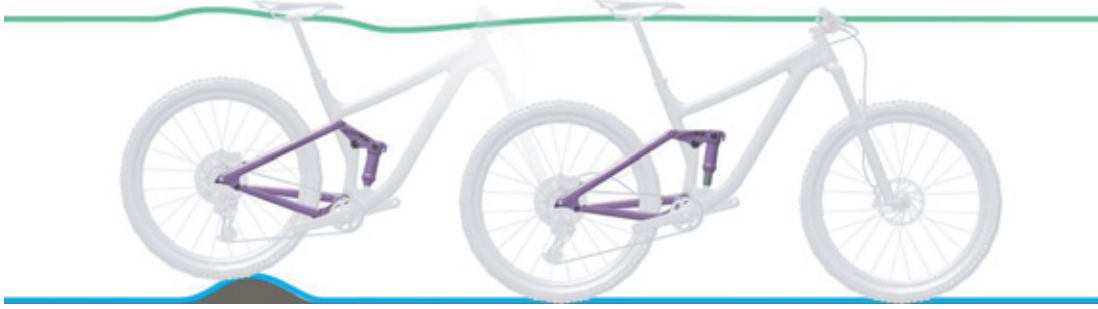
Rysunek 17: Optymalne działanie tylnego amortyzatora na nierównościach
