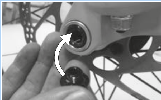
Rysunek 69: Sposób wsuwania dźwigni zacisku szybkomocującego w oś
