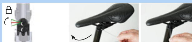
Rysunek 200: Zamykanie mechanizmu regulacji wysokości
