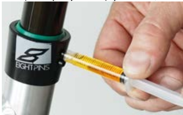
Rysunek 148: Smarowanie rury sztycy podsiodłowej
