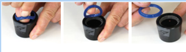
Rysunek 173: Wyciąganie zgarniacza
