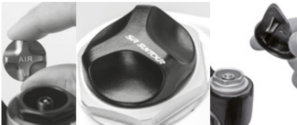
Rysunek 112: Oslony gwintowane dostępne w różnych wersjach
