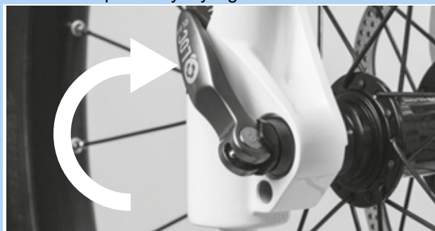
Rysunek 80: Zamykanie zacisku szybko mocującego
