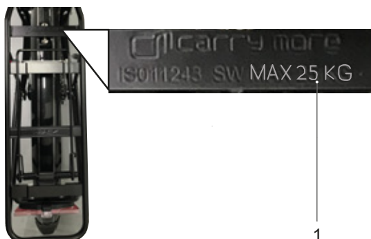
Rysunek 134: Na bagażniku umieszczona jest informacja o jego maksymalnej nośności (1)
