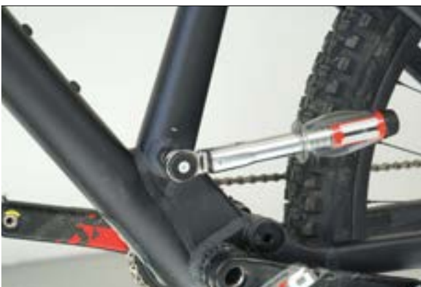
Rysunek 86: Dociąganie osi sztycy podsiodłowej
