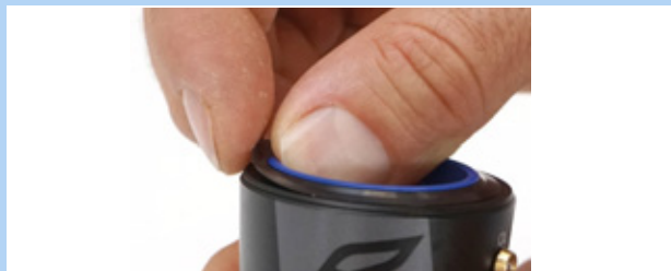
Rysunek 206: Ściąganie wargowego pierścienia uszczelniającego
