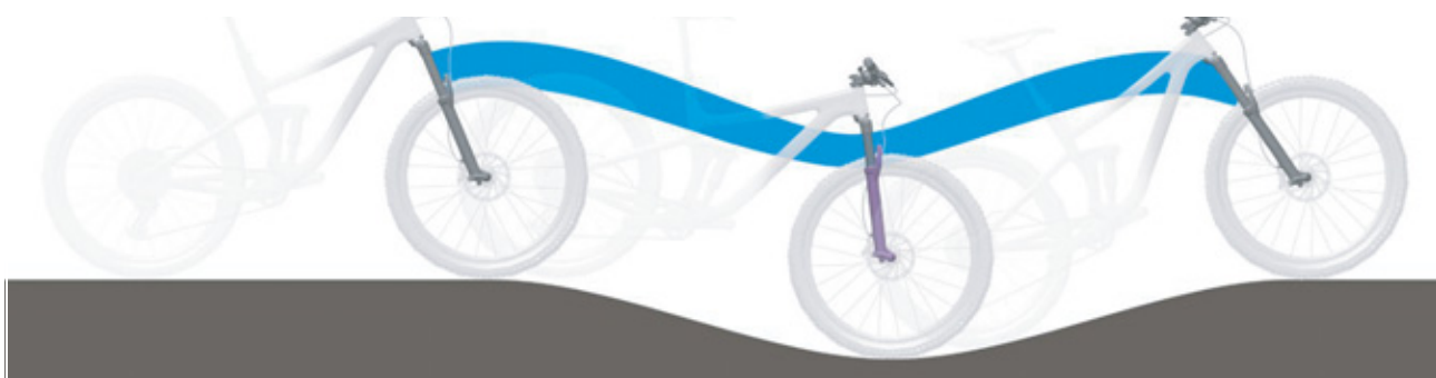
Rysunek 9: Optymalne działanie widełca na pagórkowatym terenie
