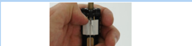
Rysunek 189: Przesuwanie białego przełącznika w dół
