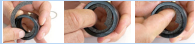
Rysunek 211: Wkładanie pierścienia filcowego
