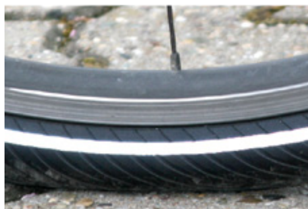
Rysunek 102: Prawidłowe ciśnienie w oponach. Opona prawie nie odkształca się pod wpływem ciężaru ciała.
