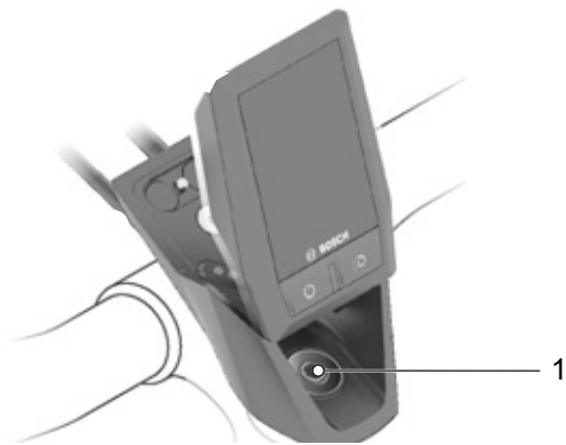
Rysunek 125: Usytuowanie śruby zespołu sterowania
