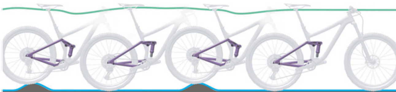
Rysunek 115: Optymalne działanie tylnego amortyzatora
