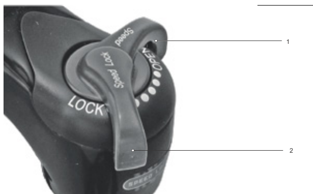
Rysunek 230: Ustawienie nastawnika dobiecia na twardszy tryb pracy
