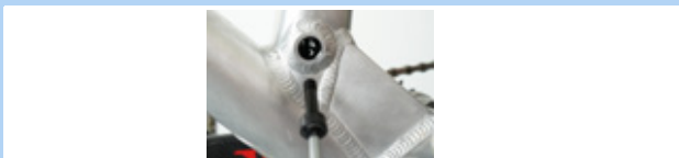
Rysunek 166: Odkręcanie osi sworznia
