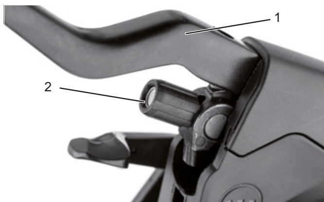
Obr. 81: Brzdová páka (1) hydraulicky ovládaných ráfkových brzd s nastavovacím šroubem (2)
