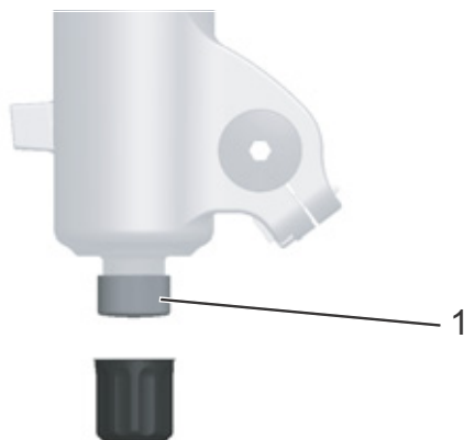
Obr. 51: Nastavovací šroub odskoku FOX na vidlici (1)
