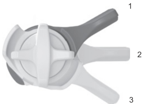
Obr. 54: Nastavovací šroub komprese FOX na tlumiči zadního odpružení s polohami OTEVŘENÁ (1), STŘEDNÍ (2) a TVRDÁ (3)
