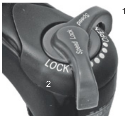
Obr. 63: Nastavovací šroub komprese Suntour s polohami OPEN (1) a LOCK (2)
