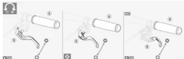
Figura 50: Ajustar el ancho de agarre de la palanca de freno con freno de disco Magura
