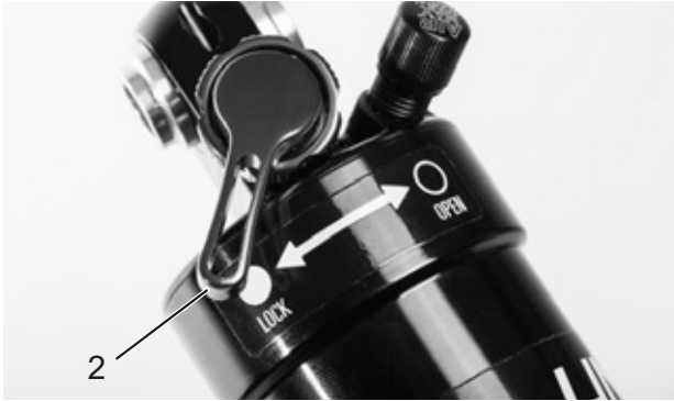
Figura 69: Regulador de niveles de presión Suntour cerrado (2)
