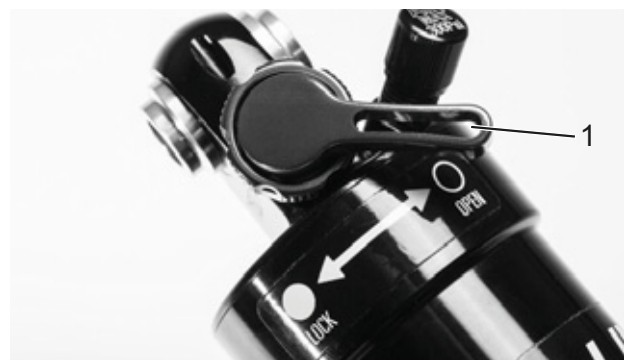
Figura 68: Regulador de niveles de presión Suntour abierto (1)
