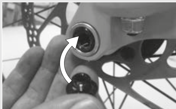
Figura 22: Inserción de la palanca de cierre rápido en el eje
