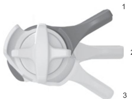
Figura 65: Regulador de niveles de presión FOX en el amortiguador de la horquilla trasera con las posiciones ABIERTO (1), MEDIO (2) y DURO (3)
