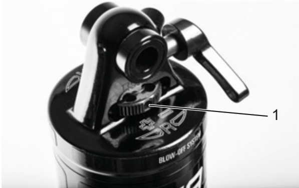
Figura 56: Rueda del regulador de niveles de tracción Suntour (1) en el amortiguador de la horquilla trasera
