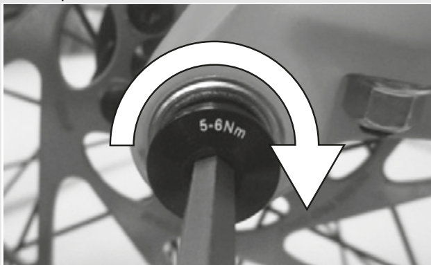
Figura 23: Apriete del tornillo de seguridad
