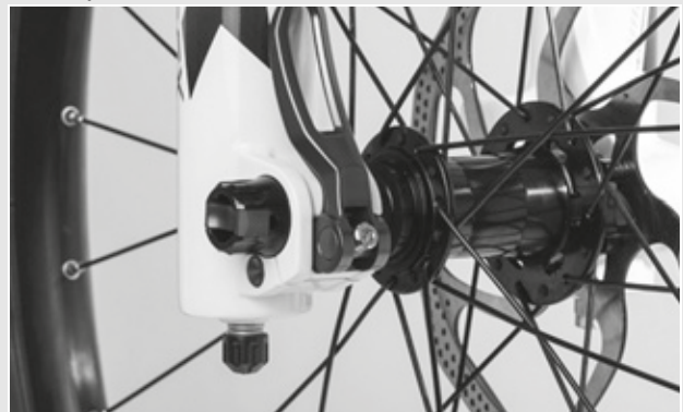
Figura 75: Ajuste de la fuerza de tensado del cierre rápido
