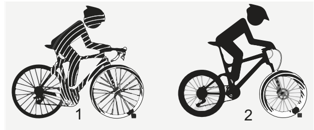
Figura 4: Pedelec sin suspensión (1) y con suspensión (2) en caso de conducción sobre obstáculo
