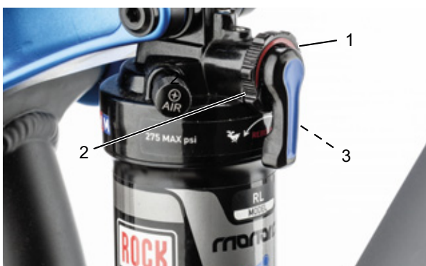
Figura 70: Ajuste de la dureza del amortiguador de niveles de tracción en la rueda de ajuste (1) del amortiguador de la horquilla trasera
